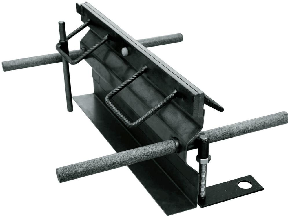
Ausführung als verlorene Schalung an Arbeits-/Pressfugen in **hochbeanspruchten Betonnutzflächen**. Als Fugenkantenschutz und zur Querkraftübertragung durch Runddübel. Konstruktion mit Stahlkantenschutz, stufenloser Höhenjustierung (bei Verwendung von Unterstützungsfüssen), Fließbarriere (optional), U-Betonanker und Runddübelhülsen. Befahrbar mit Flurförderfahrzeugen, PKW und LKW.
