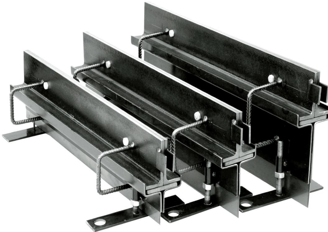
Ausführung als verlorene Schalung an Arbeits-/Pressfugen in **hochbeanspruchten Betonnutzflächen**. Als Kantenschutz und zur zwangsfreien Lastübertragung auf voller Profillänge ohne Verdübelung. Konstruktion mit Stahlkantenschutz, Höhenjustierung, Fließbarriere, Flachstahl zur Lastübertragung und Betonanker. Befahrbar mit Flurförderfahrzeugen, PKW und LKW.
