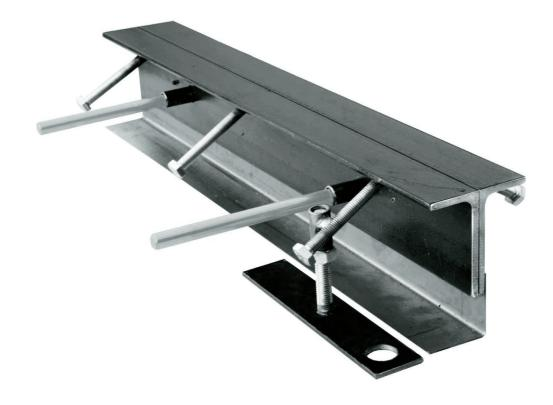
Ausführung als verlorene Schalung für **Bodenplatten mit geringer Plattendicke (7-14 cm)**. Stufenlos höhenjustierbar, wahlweise mit oder ohne Querkraftübertragung mittels Runddübeln, zur Ausbildung und zum Schutz vor Beschädigungen an Arbeitsfugen in **hochbeanspruchten Industrienutzböden** aus Beton. Befahrbar mit Flurförderfahrzeugen, PKW und LKW.
