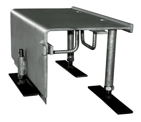
Verzinkte Ausführung als Anschluss im **Tür- und Torbereich** in **hochbeanspruchten Beton-nutzflächen**. Als Kantenschutz und zum **Schutz gegen das Eindringen von Regenwasser** bei Rolltoren. Konstruktion mit Stahlkantenschutz, Höhenjustierung, Fliessbarriere und Wassersperre. Befahrbar mit Flurförderfahrzeugen, PKW und LKW.
