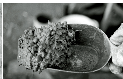
Homogene Verteilung der Stahlfasern innerhalb der Betonmatrix
